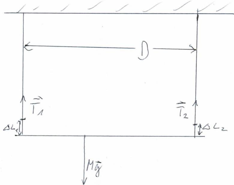
Comme les fils ont une longueur différent, la tige n'est pas horizontale initialement, et il faut que la déformation des deux soit différent pour arriver à des longueurs identiques :
