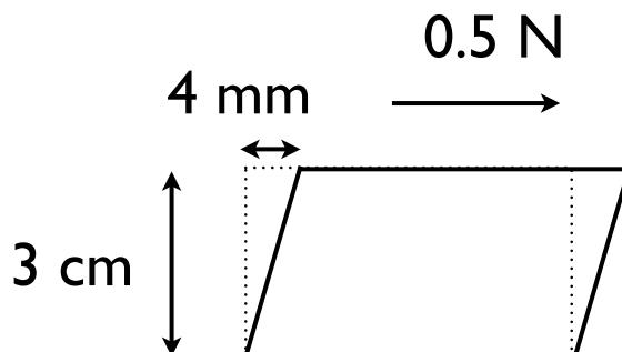
Soit  $F = 0.5 \text{ N}$  la force appliquée,  $h = 3 \text{ cm}$  l'hauteur du gâteau,  $d = 4 \text{ mm}$  la déplacement de la partie supérieure. La force est appliquée sur la surface supérieure (non visible),  $S = 15 \text{ cm}^2$ . On suppose que la déformation est un cisaillement simple, pour lequel la relation suivant est valable :
